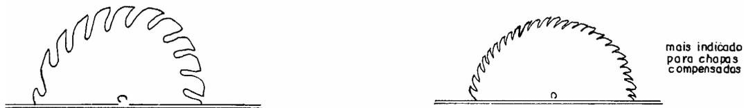
**Figura 11.6 - Tipos de disco para corte de tábuas e chapas compensadas**
