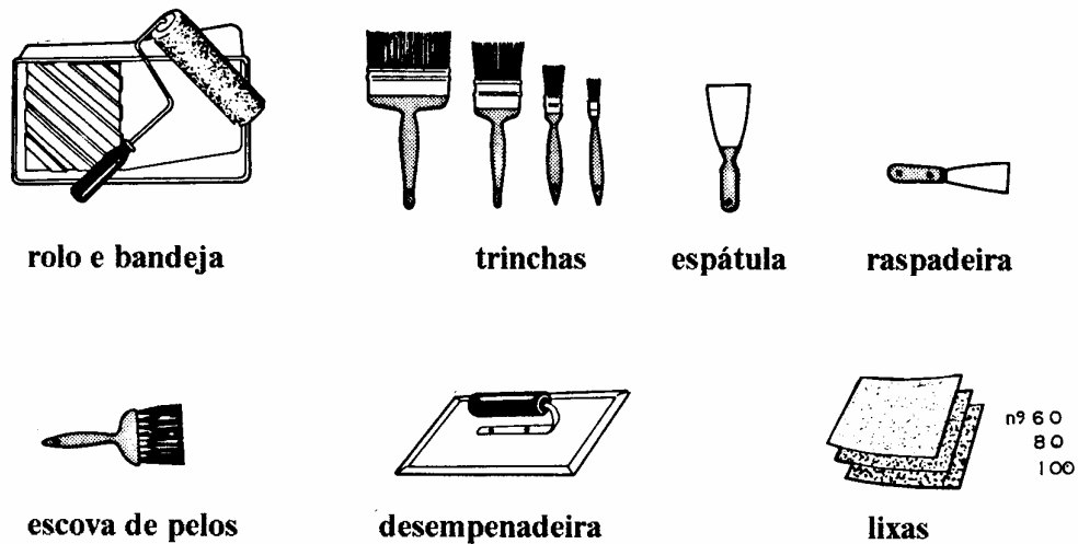
Figura 9.3 - Materiais utilizados no preparo e aplicação das pinturas em paredes
